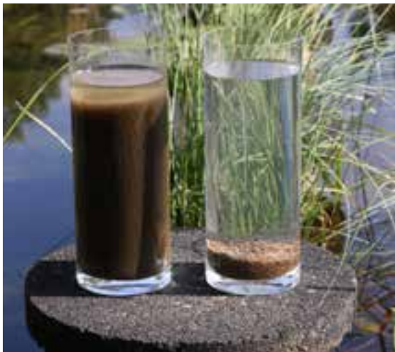
Twee glazen met slib (linker glas) en Nereda-korrels (rechter glas) laten het verschil in bezinkingssnelheid zien.
