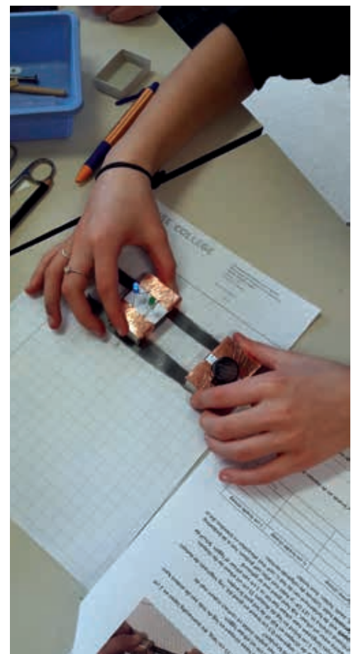
Ontdekken hoe fel de led brand op grotere afstand met geleider grafiet.
