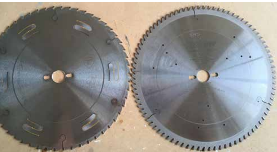
Figuur 1. Een Low-Noise cirkelzaagblad links en normaal zaagblad rechts
