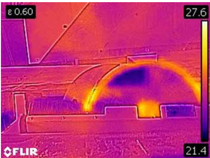
Figuur 5. IR- en zichtbaar lichtfoto van een zaagblad
