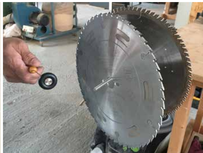
Figuur 2. Geluidsterkte opstelling van de \text{Æ}350 mm cirkelzagen
