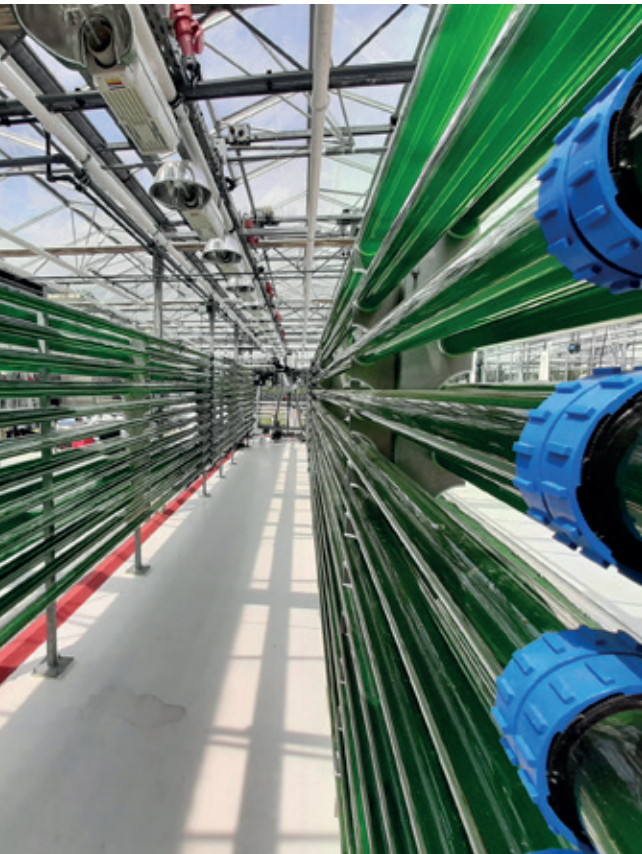
Fotobioreactor voor de productie van micro-algen bij AlgaePARC.
