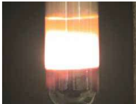
Figuur 1. Het oplichten tussen de twee vloeistofflagen bij de demo Onweer onder water . Foto: Kees Kampfraath
