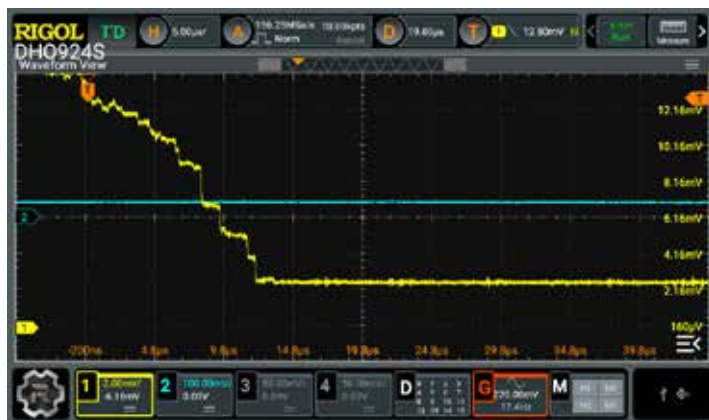
Figuur 3b. Ingezoomd op het rode cirkeltje van figuur 3a ziet het signaal er heel anders uit ( t = 5 \text{ } \mu\text{s/vakje} , U = 2 \text{ mV/vakje} )
