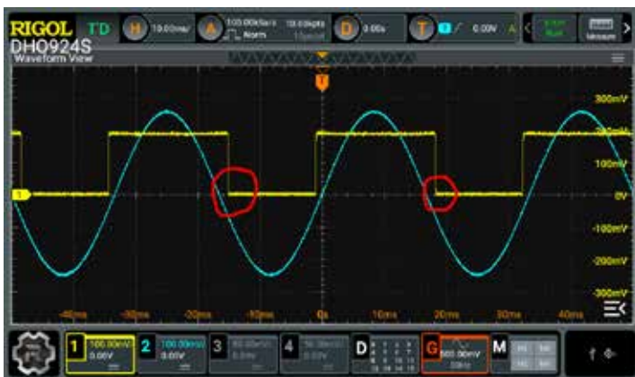
Figuur 3a. De signalen van de luidspreker (blauw) en van de spanningsdeler (geel). De momenten waarop het signaal verbreekt zijn met een rood cirkeltje aangegeven. ( t = 10 \text{ ms/vakje} , U_{uit} = 100 \text{ mV/vakje} ).
