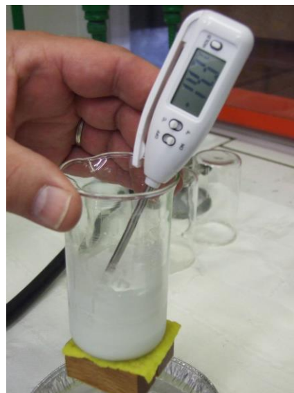
De thermometer wijst -14,3^{\circ}\text{C} aan. Het bekglas is vastgevroren aan het stukje hout met de vochtige doek.
