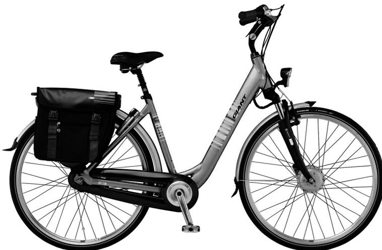
Bij een snelheid van 20 km/h is het afgegeven vermogen van de accu 250 W.
