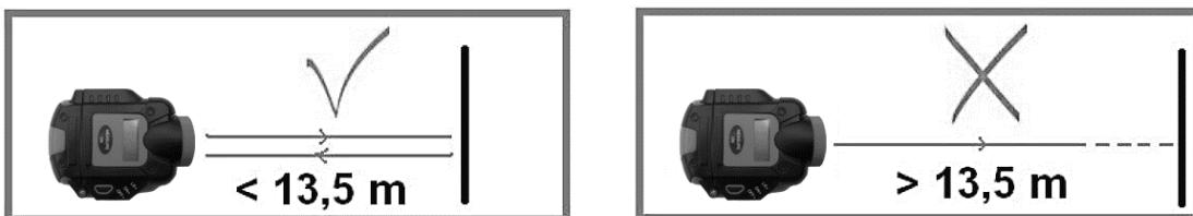
Waarom kan de afstandsmeter geen grotere afstanden meten?
