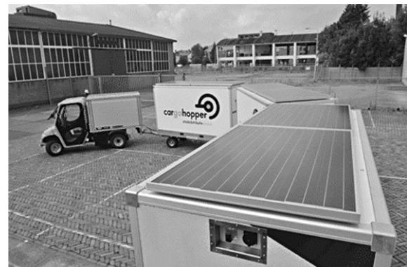
zonnepanelen op dak van laadbakken
