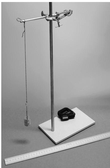
Bart trekt de blokjes 4 cm uit de evenwichtsstand en Glenn meet met een stopwatch de tijd van 10 slingeringen. Ze herhalen de meting bij verschillende slingerlengtes. Je ziet een tabel met hun meetresultaten.
