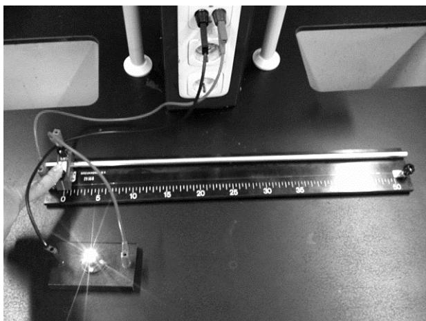
Op een gelijkspanningsbron sluiten ze een gloeilampje aan in serie met een draadweerstand. De lengte van de draad is instelbaar door een aansluitpunt te verplaatsen.
