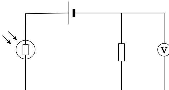
De weerstanden verhouden zich als de spanningen over de weerstanden. Omdat de som van twee spanningen gelijk is aan de batterijspanning, is hiermee de weerstand van de LDR te bepalen.
