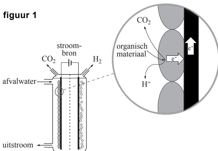
De elektrolysecel bestaat uit twee compartimenten, gescheiden door een membraan. Door het linkercompartiment stroomt afvalwater met daarin organisch materiaal. In het rechtercompartiment bevindt zich een andere geleidende oplossing. De elektroden zijn van koolstof. De elektrode in het linkercompartiment is bedekt met de bacteriën (de grijze ovalen in de detailtekening).
